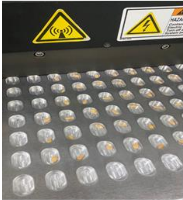
ภาพ 3.19 นำธาตุหลุมอลูมิเนียมไปวางในเครื่อง DBD
